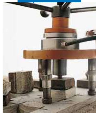
Δοκιμή πρόσφυσης κατά SATTEC
